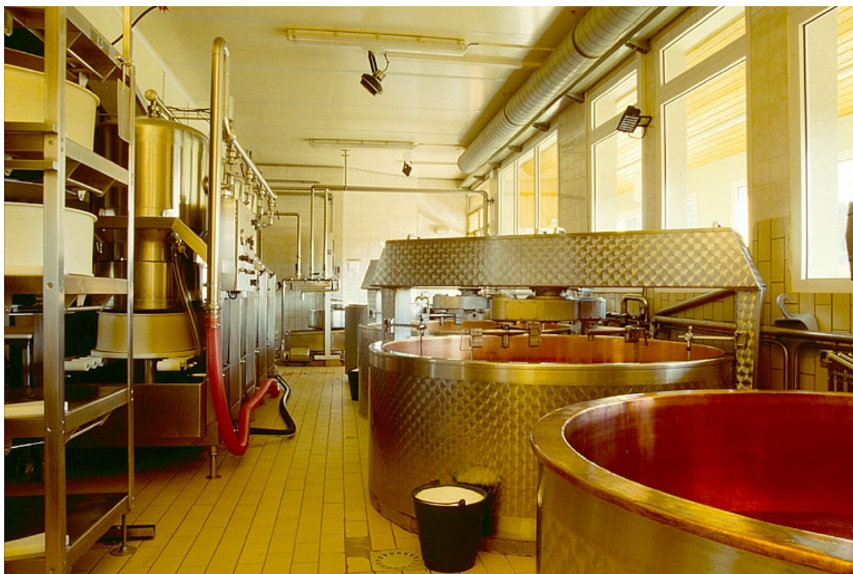
Intérieur de l'atelier de fabrication du comté. Cuves à droite, soutirage sous vide à gauche.
