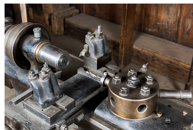
Partie travaillante : mandrin sur la poupée fixe à gauche, burins au centre et tourelle revolver à droite.
