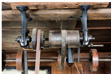
Système de transmission au plafond.
