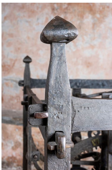
Face latérale droite : système d'assemblage des montants et marques de repérage. Phot. Sonia Dourlot IVR43_20193900082NUC4A
