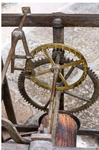
Corps avant droit (partage du temps) : échappement à chevilles, vu en plongée. La roue d'échappement (en laiton) est munie de chevilles qui interagissent avec l'ancre à gauche. Phot. Sonia Dourlot IVR43_20193900087NUC4A
