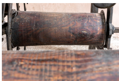
Corps arrière droit (sonnerie des quarts d'heure) : tambour en bois. Phot. Sonia Dourlot IVR43_20193900081NUC4A
