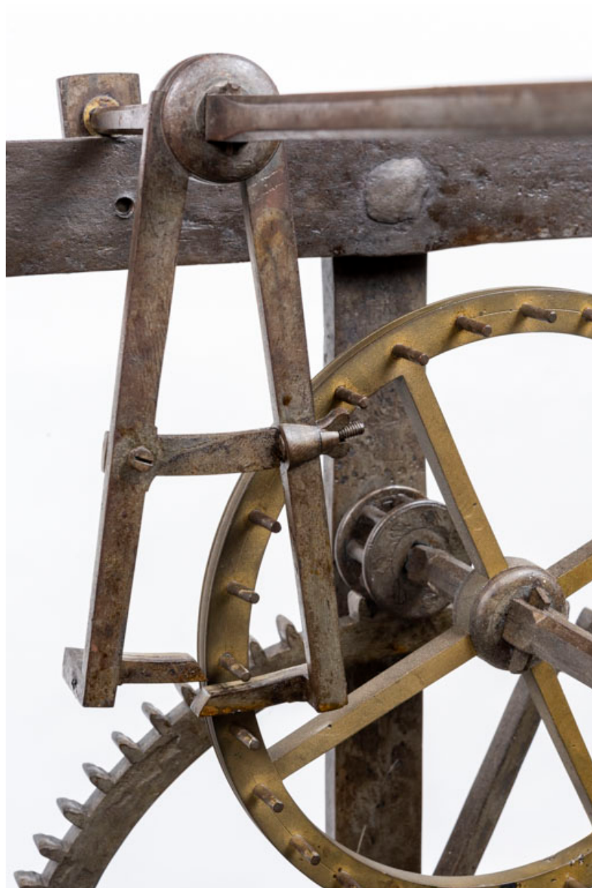
Echappement à chevilles : ancre et roue d'échappement.
