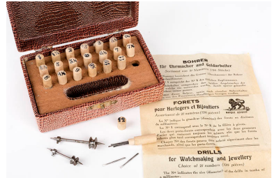
Forets pour horlogers et bijoutiers réalisés par Narcisse Moyse (collection René Laithier, mairie des Gras). Phot. Sonia Dourlot IVR43_20172500502NUC4A
