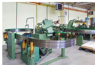
Scierie : détail des machines à affûter les lames de scie. Phot. Sonia Dourlot IVR43_20143900623NUC2A
