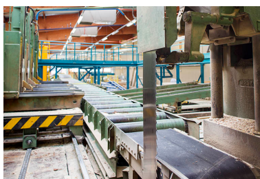
Scierie : tapis pour débiter les grumes en planches. Phot. Sonia Dourlot IVR43_20143900646NUC2A
