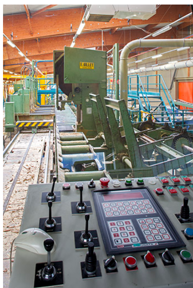
Scierie : machine à commande numérique pour débitage. Phot. Sonia Dourlot IVR43_20143900645NUC2A
