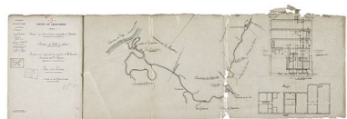
Révision du règlement des moulins de La Truchère, demande des Sieurs Lappe : plan des lieux", par Gardie, conducteur principal faisant fonction d'ingénieur ordinaire, le 8 octobre 1895, visé par Jozon, ingénieur en chef. Petit plan de la Seille, puis coupe et plan au sol du moulin. Sur
