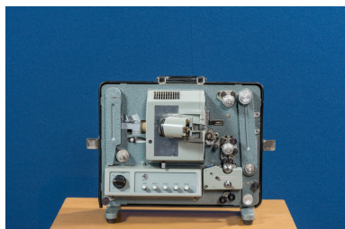
Face avant, objectif replié en position de transport. Phot. Pierre-Marie Barbe-Richaud IVR26_20257100460NUC4A
