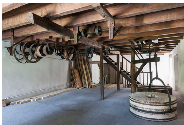
Premier étage. Transmission par poulies et meules. Phot. Jérôme Mongreville IVR43_20152501750NUC4A
