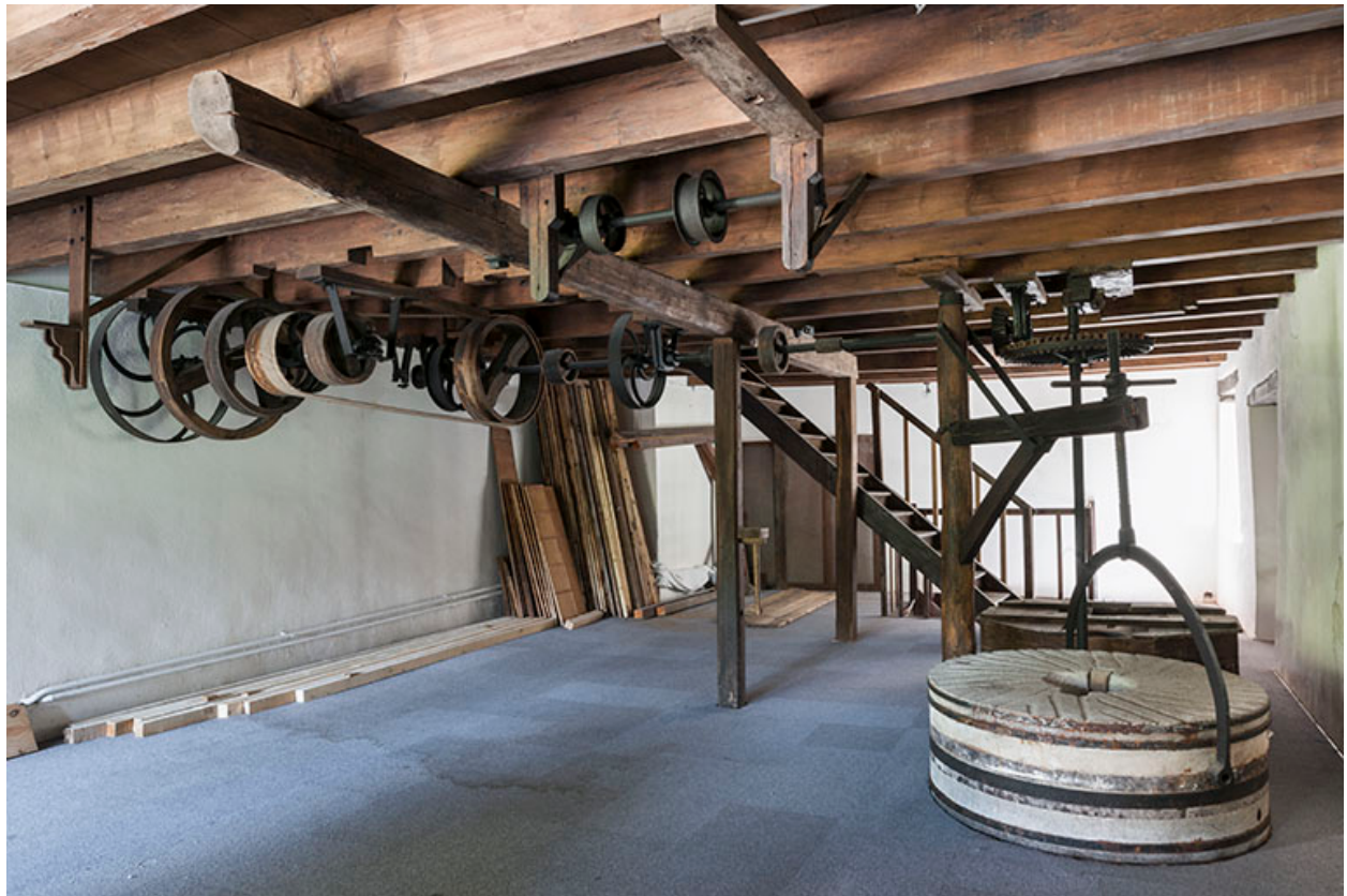
Premier étage. Transmission par poulies et meules.
