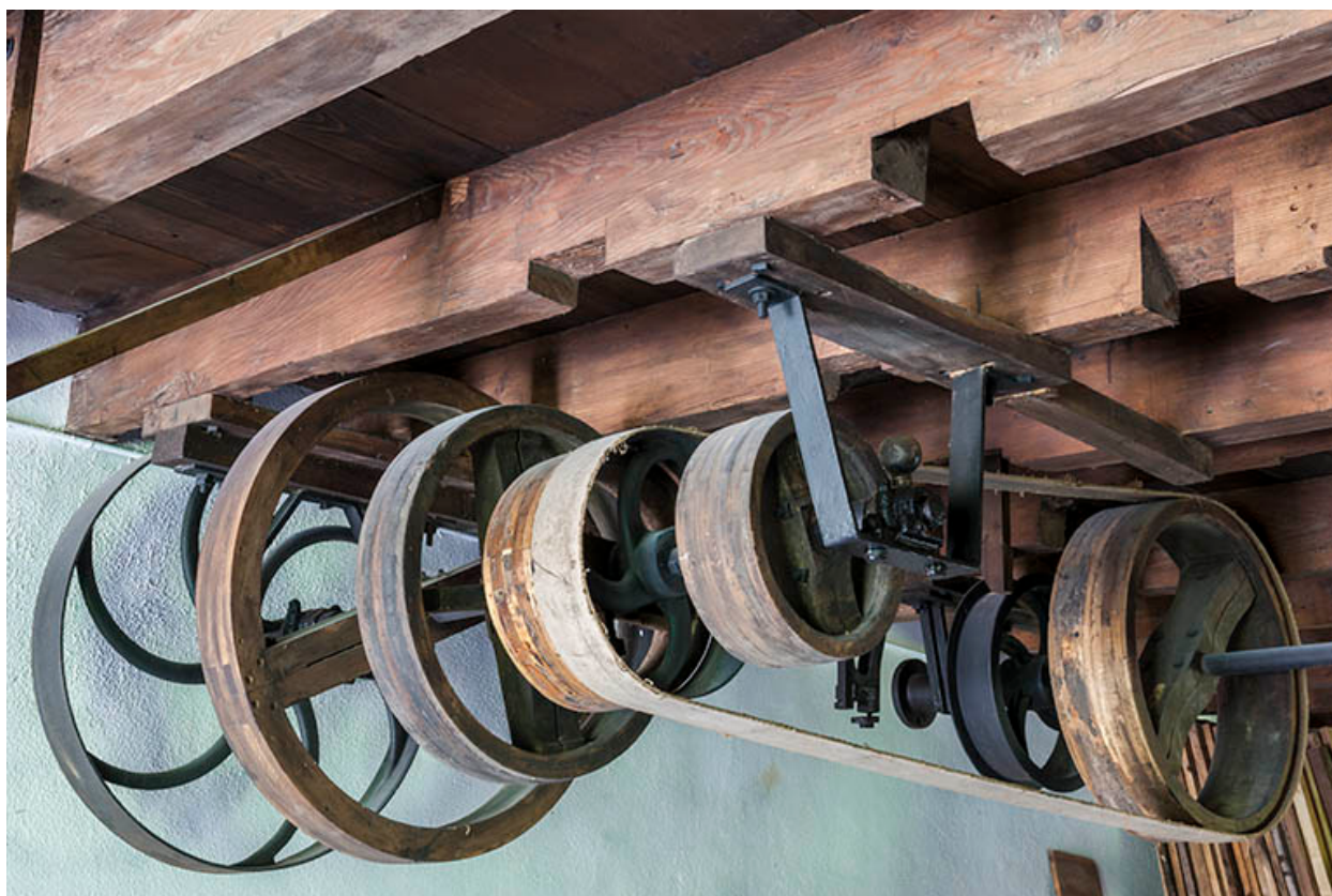
Détail de la transmission par poulies.
