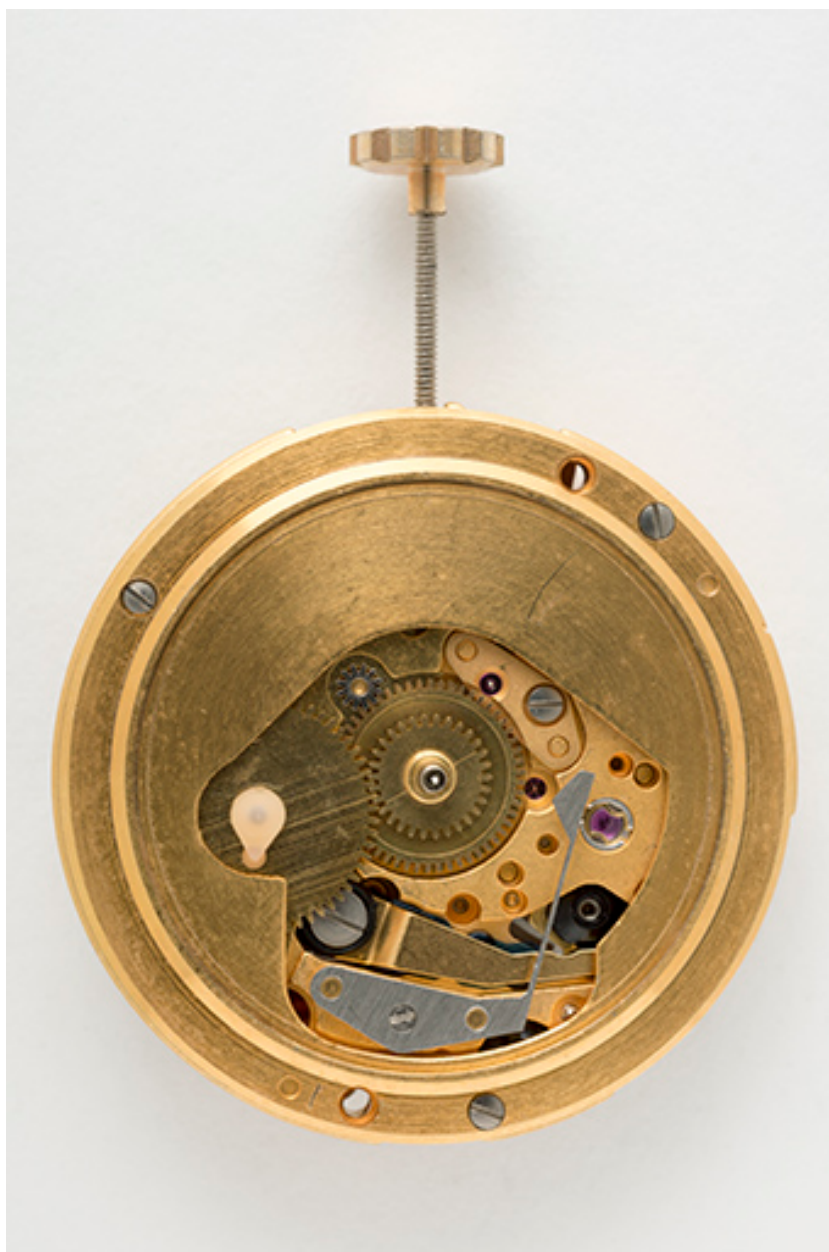
Mouvement Lip R 148, vu côté cadran.
