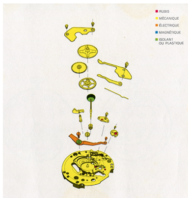
Lip Electronic R 148 [présentation sous forme d'éclaté : côté cadran], années 1960.
