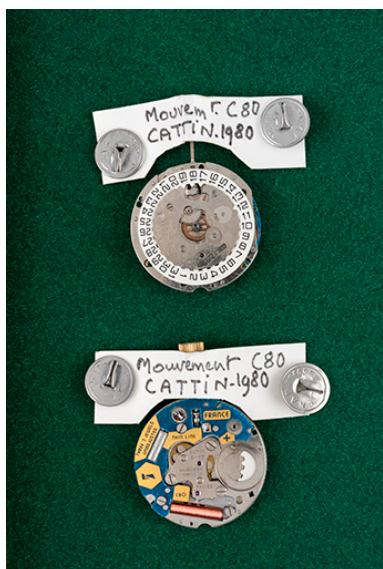
Modules à quartz Cattin C 80 (1980), étudiés par le Cetehor. (Collection Cetehor, Besançon). Phot. Sonia Dourlot IVR43_20192500306NUC4A
