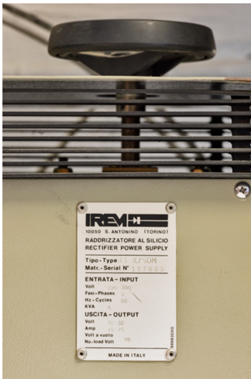
Plaque signalétique du redresseur Irem.
