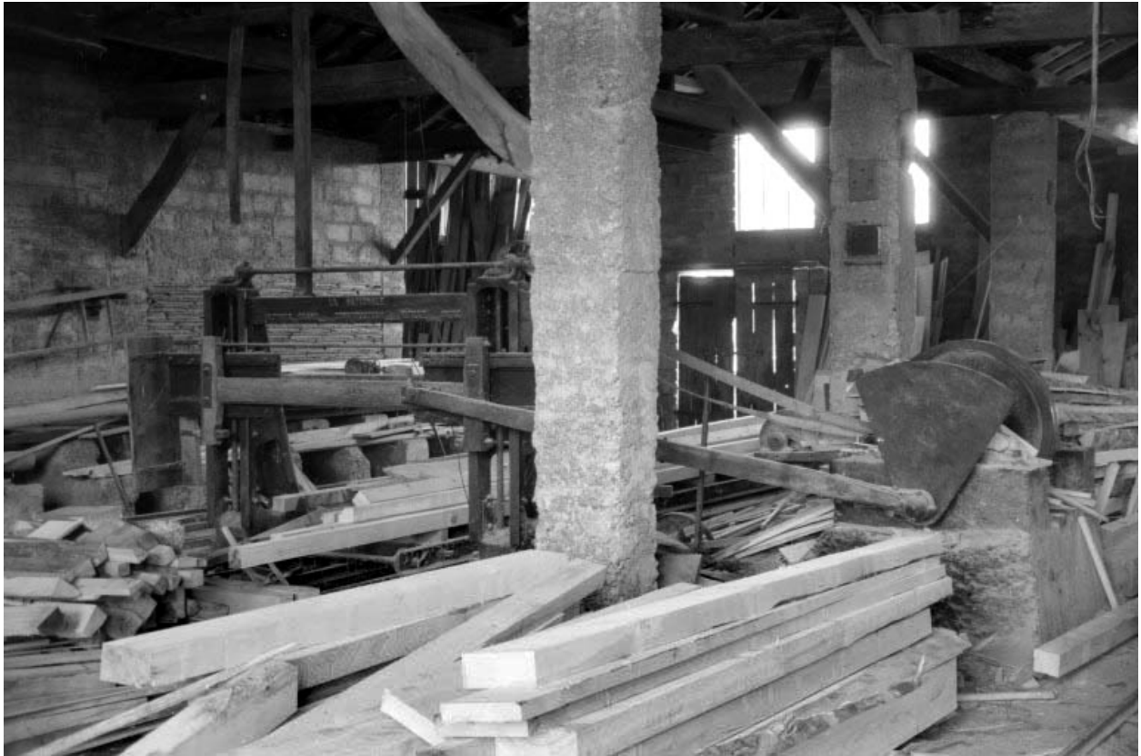
Scie à châssis horizontal, de trois quarts droit.
