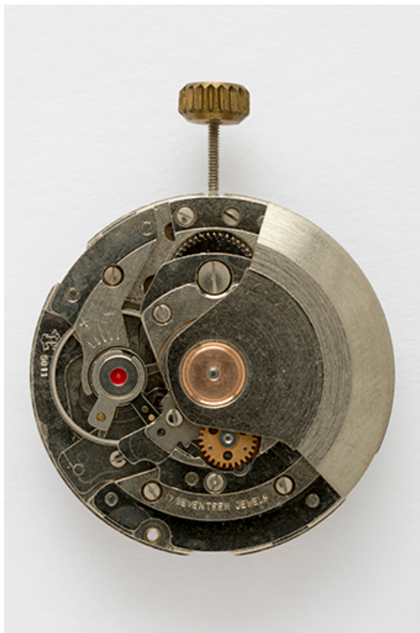
Mouvement France Ebauches FE 5611 : face côté ponts.
