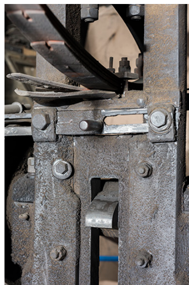
Martinet vertical : la came (avec, au-dessus, la poignée du système d'embrayage et le bas des ressorts).
