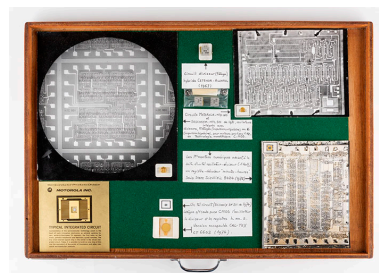
Circuits électroniques pour montre à quartz dont, en haut, un circuit diviseur hybride Cetehor-Alcatel (1967). Phot. Sonia Dourlot IVR43_20192500307NUC4A
