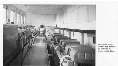
Service officiel de contrôle des montres : les batteries de chronocomparateurs, 1964.
