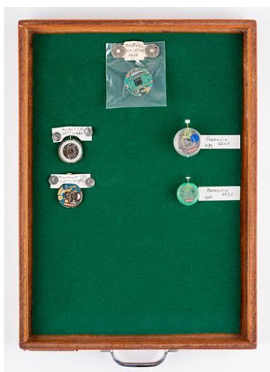
Modules à quartz étudiés par le Cetehor : Montrelec MTC-61 NU (1976), Cattin C 80 (1980), Parrenin 6641 (1980) et 6871 (1981). Phot. Sonia Dourlot IVR43_20192500305NUC4A
