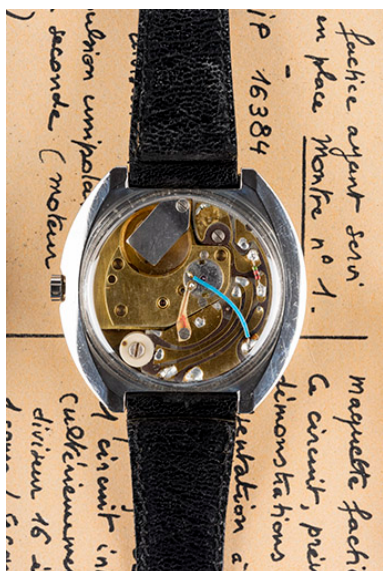
Prototype n° 3 de montre à quartz du Cetehor (mars 1972). Phot. Sonia Dourlot IVR43_20192500303NUC4A
