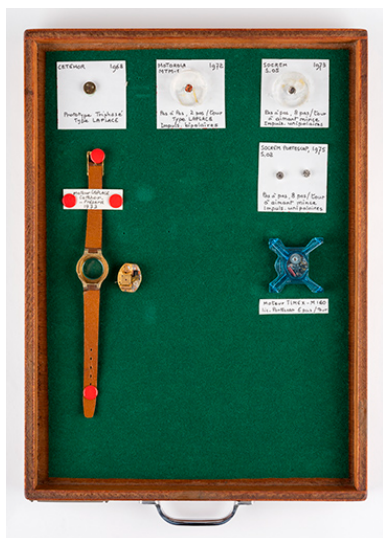
Moteurs pour montre à quartz (1968-1975), dont deux prototypes Laplace du Cetehor (1968 et 1973). Phot. Sonia Dourlot IVR43_20192500304NUC4A
