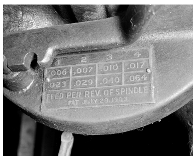
Détail de la plaque de la boîte de vitesses. Phot. Yves Sancey IVR43_20022500903X
