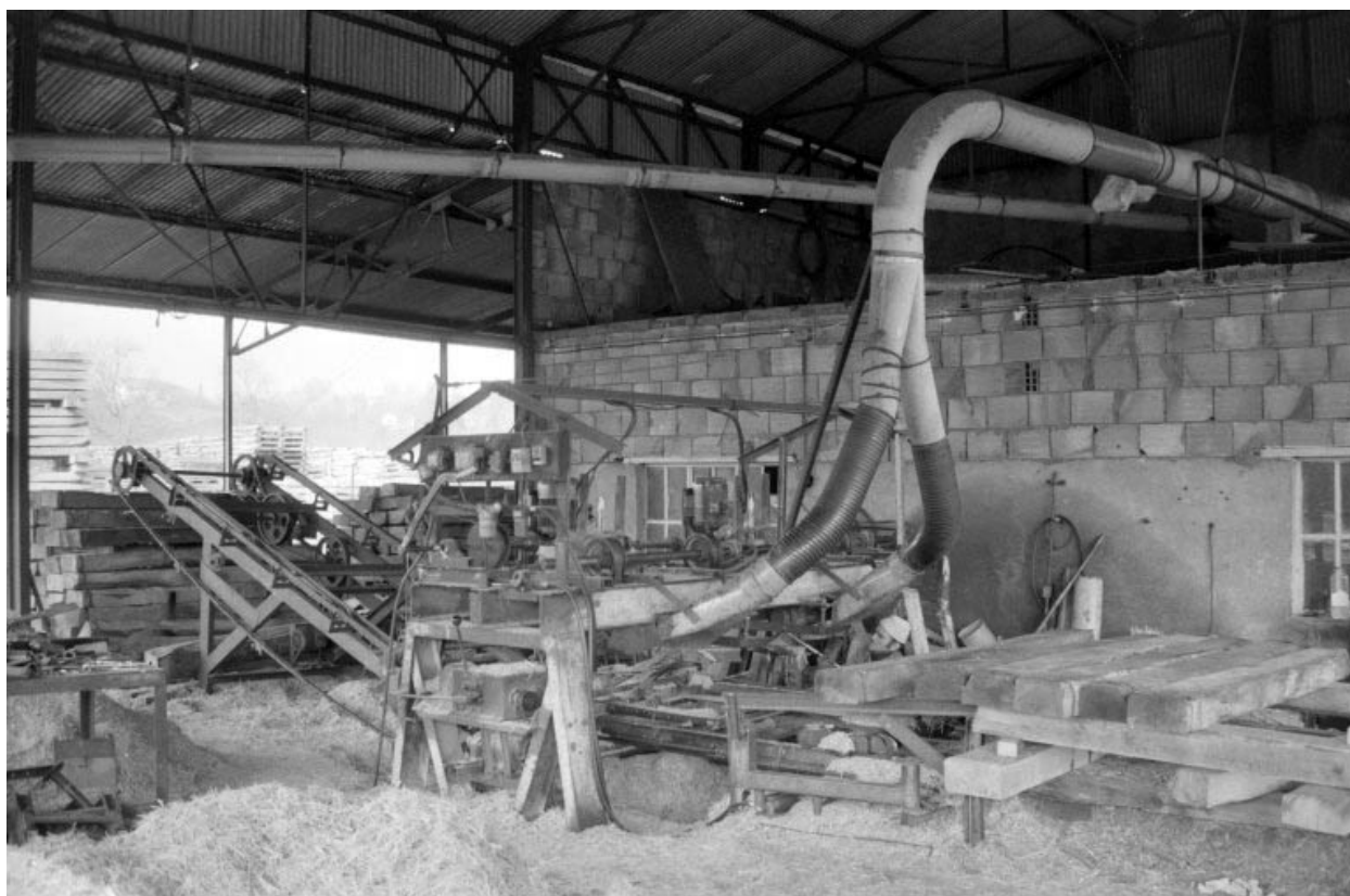
La machine à apprêter les traverses.
