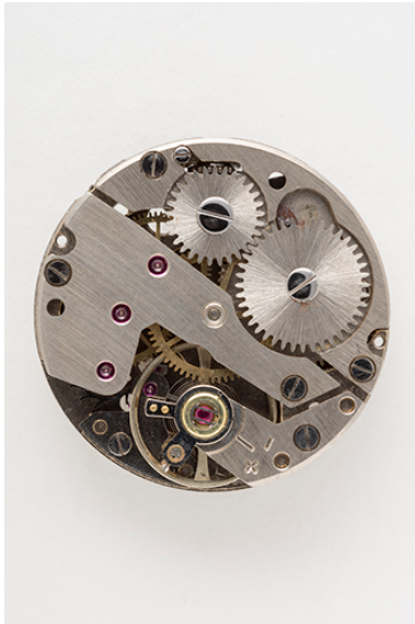
Mouvement Cupillard 233-60, vu côté ponts. Phot. Sonia Dourlot IVR43_20152502561NUC4A
