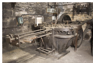
Atelier est. Machine à refouler dite "locomotive" (provient des Forges de Fraisans). Phot. Jérôme Mongreville IVR43_20087000828NUC2A
