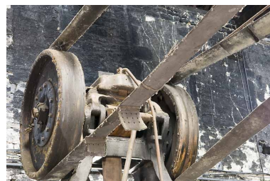
Atelier est. Marteau-pilon. Détail de la transmission supérieure par poulies et courroies. Phot. Jérôme Mongreville IVR43_20087000825NUC2A
