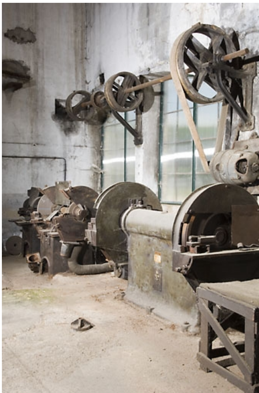
Atelier ouest. Tourets à 2 meules.
