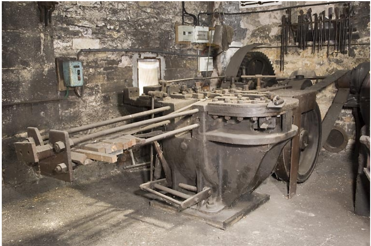
Atelier est. Machine à refouler dite "locomotive" (provient des Forges de Fraisans).
