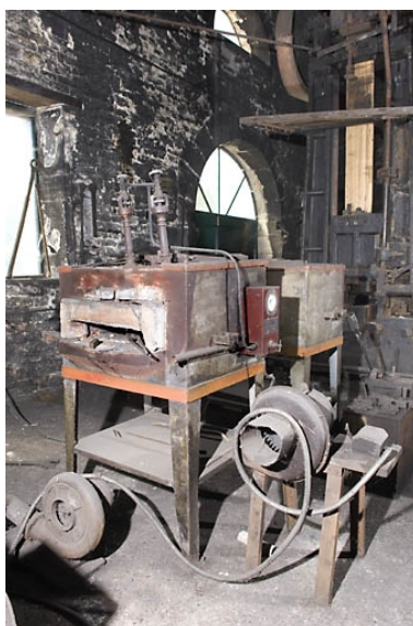
Atelier est. Fours à gaz Thermidor. Phot. Jérôme Mongreville IVR43_20087000818NUC2A
