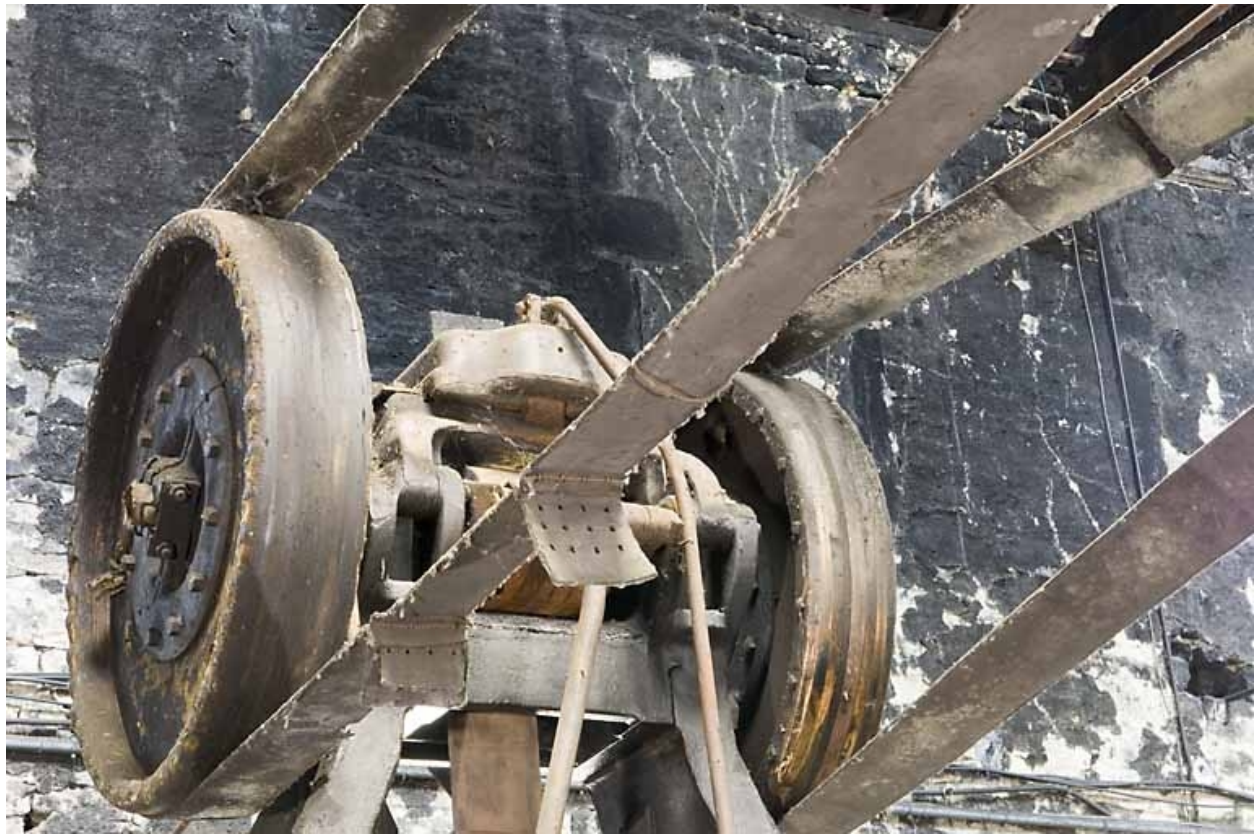
Atelier est. Marteau-pilon. Détail de la transmission supérieure par poulies et courroies.
