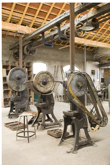
Atelier ouest. Presses "col de cygne".
