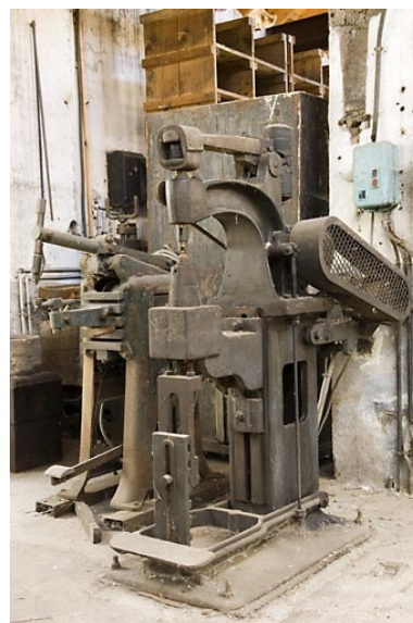
Atelier ouest. Riveteuses Pontelec et Guillemin.
