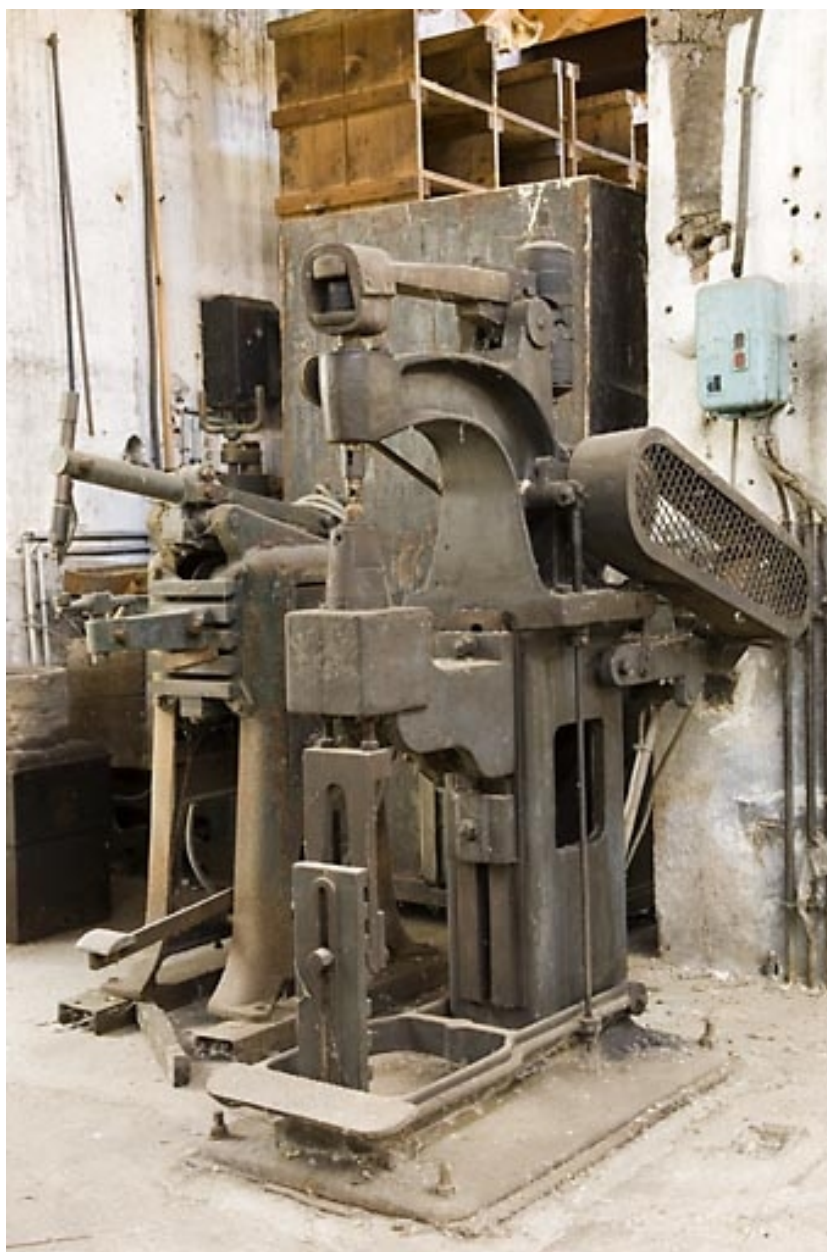
Atelier ouest. Riveteuses Pontelec et Guillemin.
