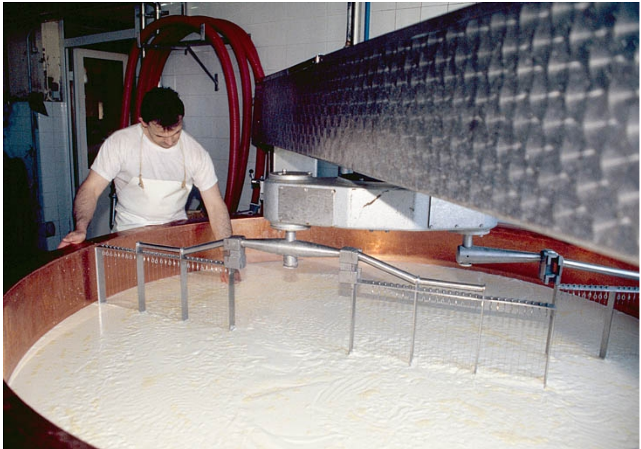
Vérification du décaillage, à la main.
