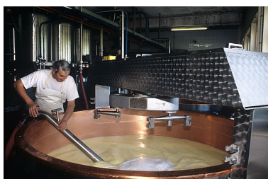
Soutirage sous vide. Phot. Jérôme Mongreville IVR43_19953900233ZA
