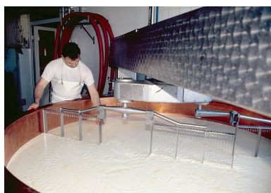
Vérification du décaillage, à la main. Phot. Jérôme Mongreville IVR43_19953900225ZA
