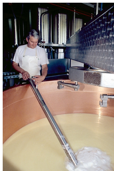
Soutirage sous vide. Phot. Jérôme Mongreville IVR43_19953900235ZA
