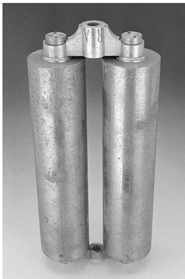
Poids double pour balancier de pendule. Phot. Jérôme Mongreville IVR43_20032500841X
