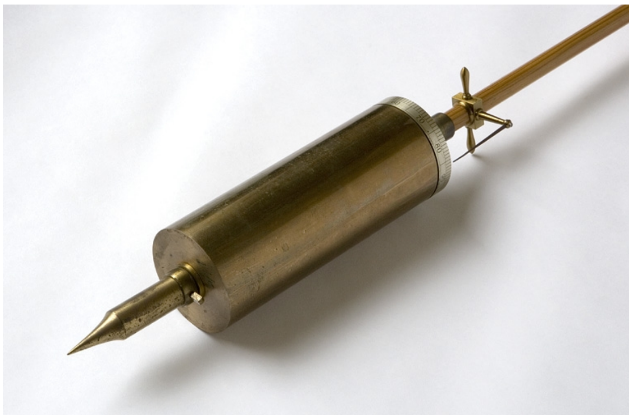
Balancier d'une horloge, avec système de réglage.
