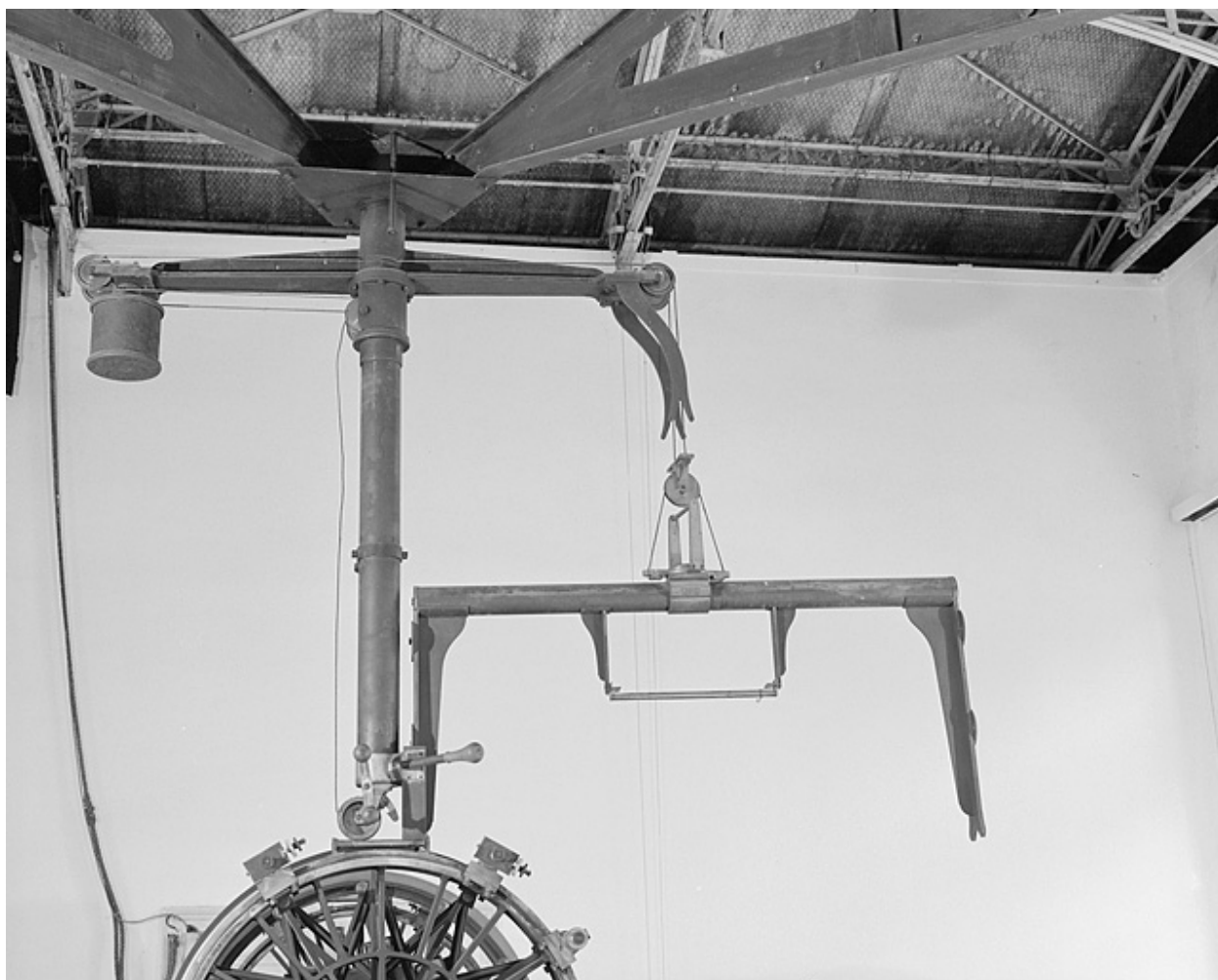
Vue latérale du support du niveau suspendu.
