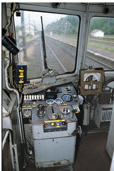
Autorail X 2800, n° X 2830 : poste de conduite.
