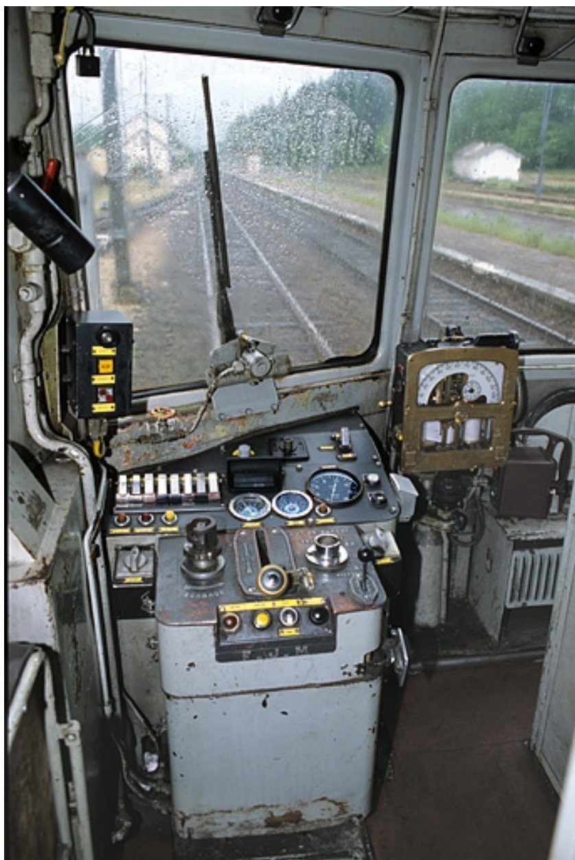
Autorail X 2800, n° X 2830 : poste de conduite.
