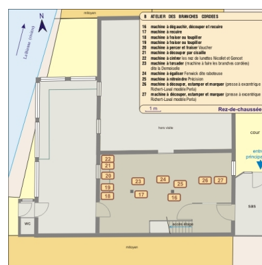
Atelier des branches cordées : schéma de distribution des machines. Echelle 1:90. Dess. André Céréza IVR43_20113900031NUDA
