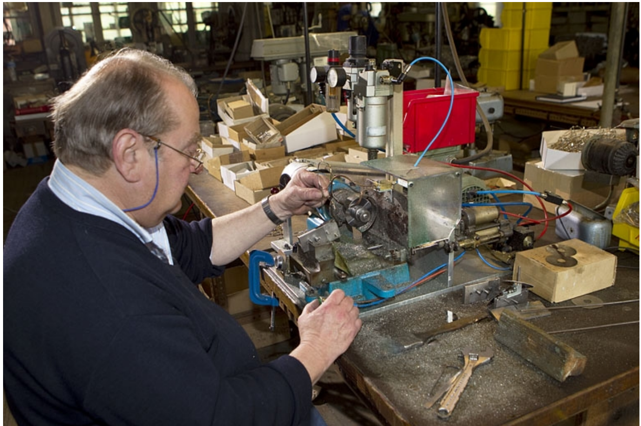
Sciage des tenons en deux (vue rapprochée).
