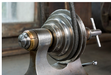
Lunette double avec l'arbre moteur, sa poulie et la pince (à gauche). Phot. Sonia Dourlot IVR43_20172500122NUC4A
