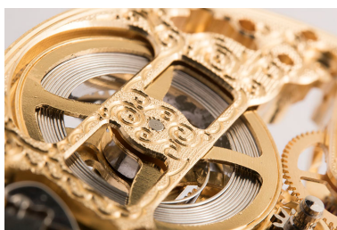
Détail : pont guilloché et ressort moteur. Phot. Sonia Dourlot IVR43_20182501153NUC4A
