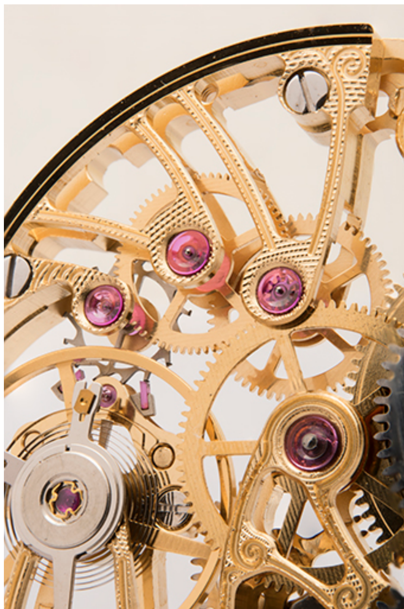
Détail : rubis et amortisseur de choc (à gauche).
