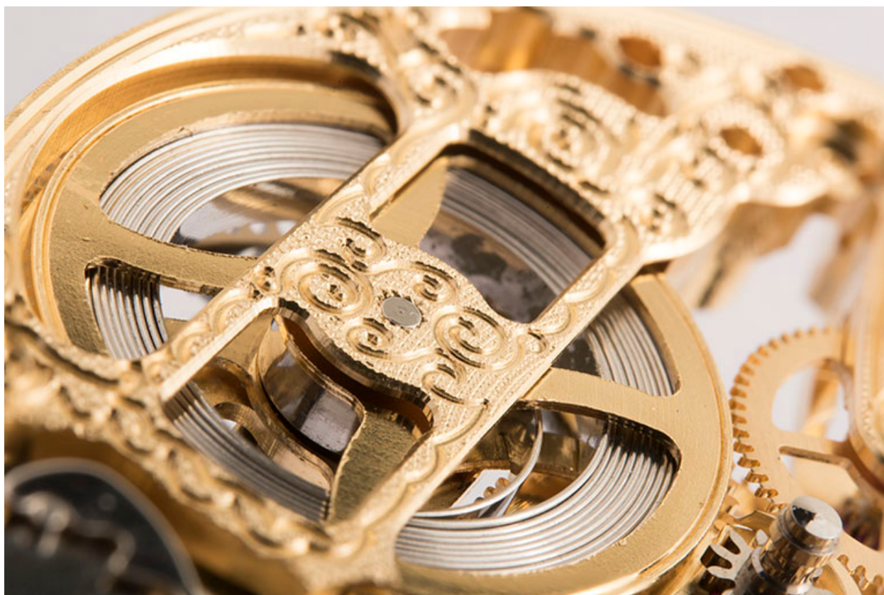
Détail : pont guilloché et ressort moteur.
