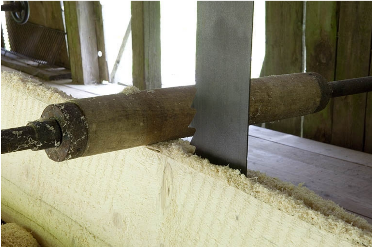
Détail de la scie du châssis.
