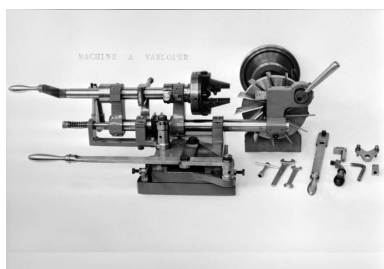
Industrie de la pipe : machine à varloper. Phot. Jérôme Mongreville IVR43_19923900296X
