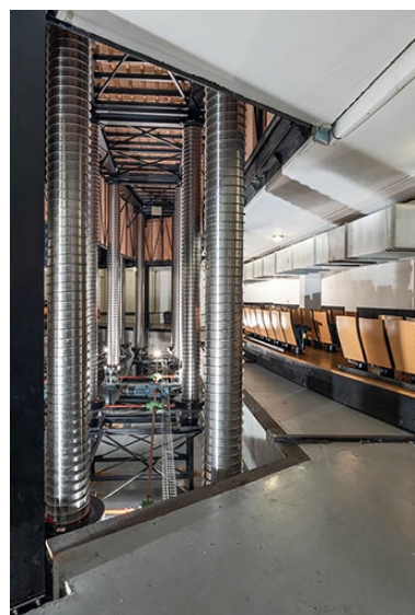
Avant-scène : colonnes Spiralift soutenant le plancher de la fosse d'orchestre (cadrage vertical). Phot. Pierre-Marie Barbe-Richaud IVR26_20212100150NUC4A
