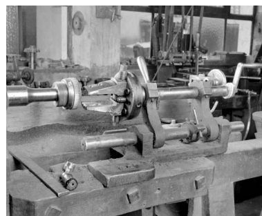
Détail de la fraise et du support de pièce, dans l'atelier d'ébauchage en 1992. Phot. Jérôme Mongreville IVR43_19923900536X
