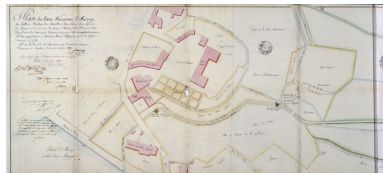
Plan du haut fourneau d'Autrey, des halles à charbon, d'un patouillet à roue [...] appartenant à messieurs Huot et Petitguyot maîtres de forges demeurant à Gray. Phot. Yves Sancey, Phot. B. Besancenot IVR43_19877000016XA
