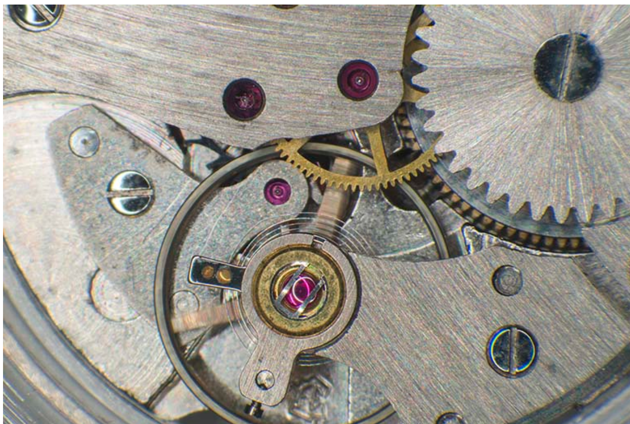
Détail : le balancier-spiral et son amortisseur de chocs (côté ponts). Le logo France Ebauches se devine en bas.
