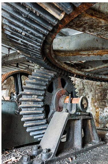
Rez-de-chaussée de l'atelier principal. Transmission par engrenages coniques de la turbine. Phot. Jérôme Mongreville IVR43_20152500387NUC4A
