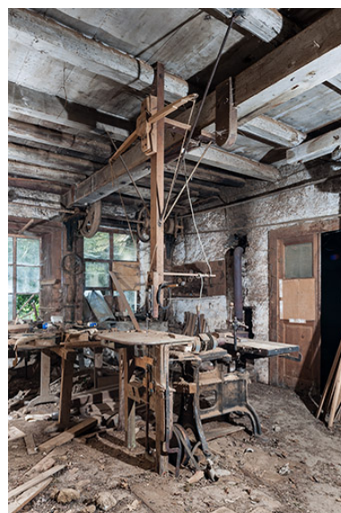
Atelier à l'étage de soubassement. Scie "arbalète" alternative et machine à mortaiser. Phot. Jérôme Mongreville IVR43_20142501289NUC4A
