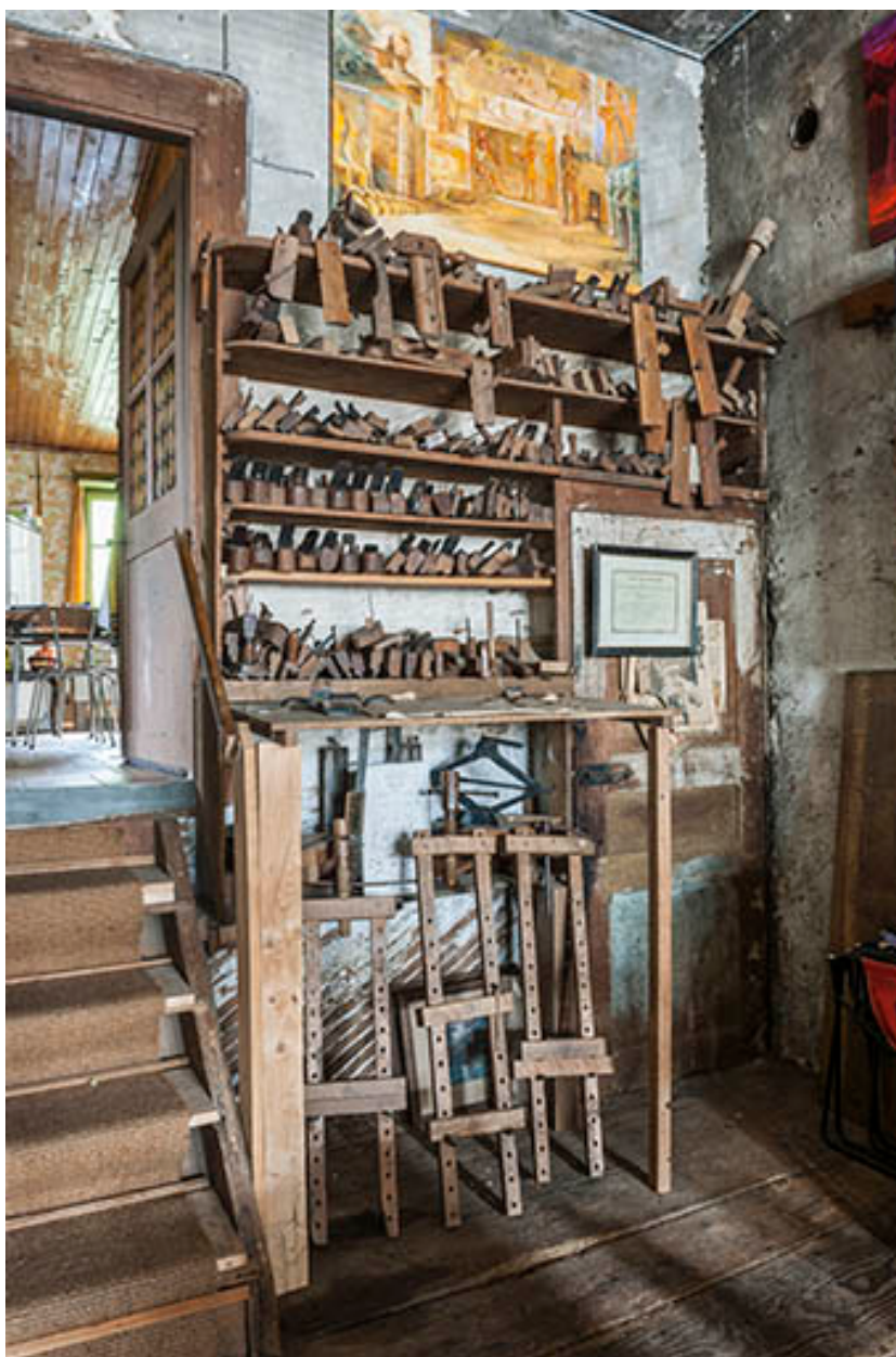
Outils divers : serre-joints, rabots, varlopes.
