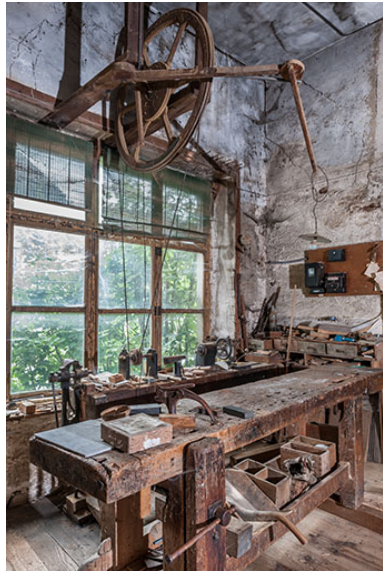
Etabli et tour à pédalier. Phot. Jérôme Mongreville IVR43_20142501281NUC4A
