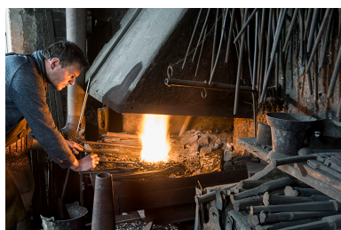
Ferme, atelier de taillanderie et de tournerie Vuillemin, Grand'Combe-Château : chauffe dans la fournaise. Phot. Sonia Dourlot IVR43_20172501596NUC4A
