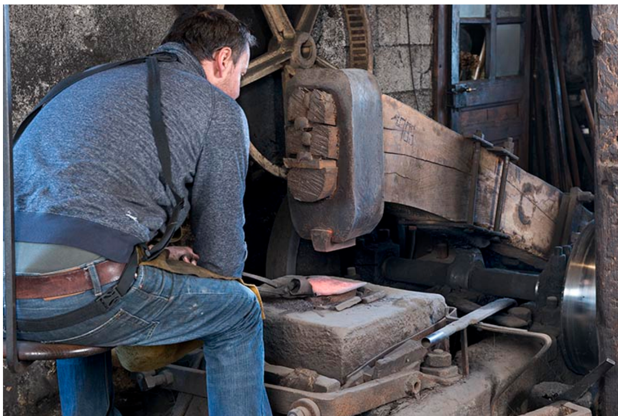
Ferme, atelier de taillanderie et de tournerie Vuillemin, Grand'Combe-Châteleu : façonnage d'un outil au martinet.
