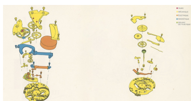
Eclaté d'un mouvement de montre Lip, 1969. IVR43_20212500082NUC2A
