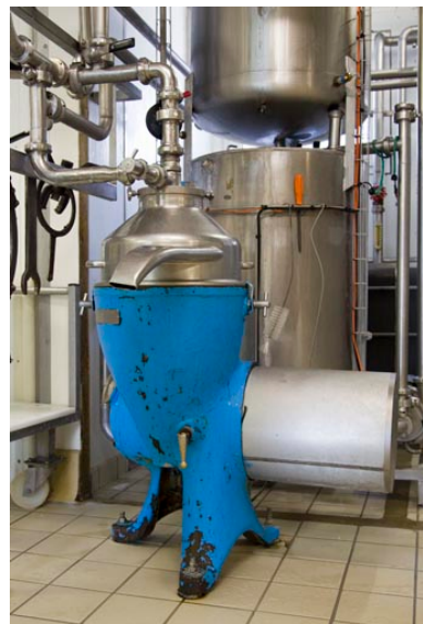
Écrémeuse Alfa-Laval. Phot. Yves Sancey IVR43_20132501223NUC2A
