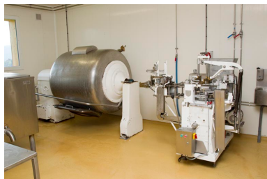
Baratte et empaqueteuse. Phot. Yves Sancey IVR43_20132501221NUC2A
