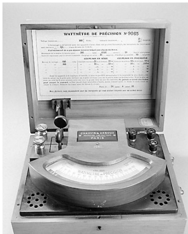
Le wattmètre. Phot. Jérôme Mongreville IVR43_20023900223X
