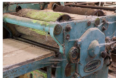
Déligneuse. Détail des rouleaux cannelés. Phot. Jérôme Mongreville IVR43_20152501836NUC4A
