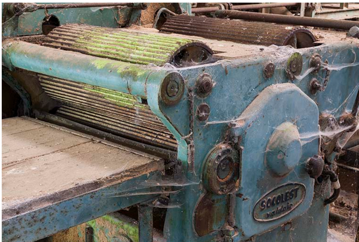
Déligneuse. Détail des rouleaux cannelés.
