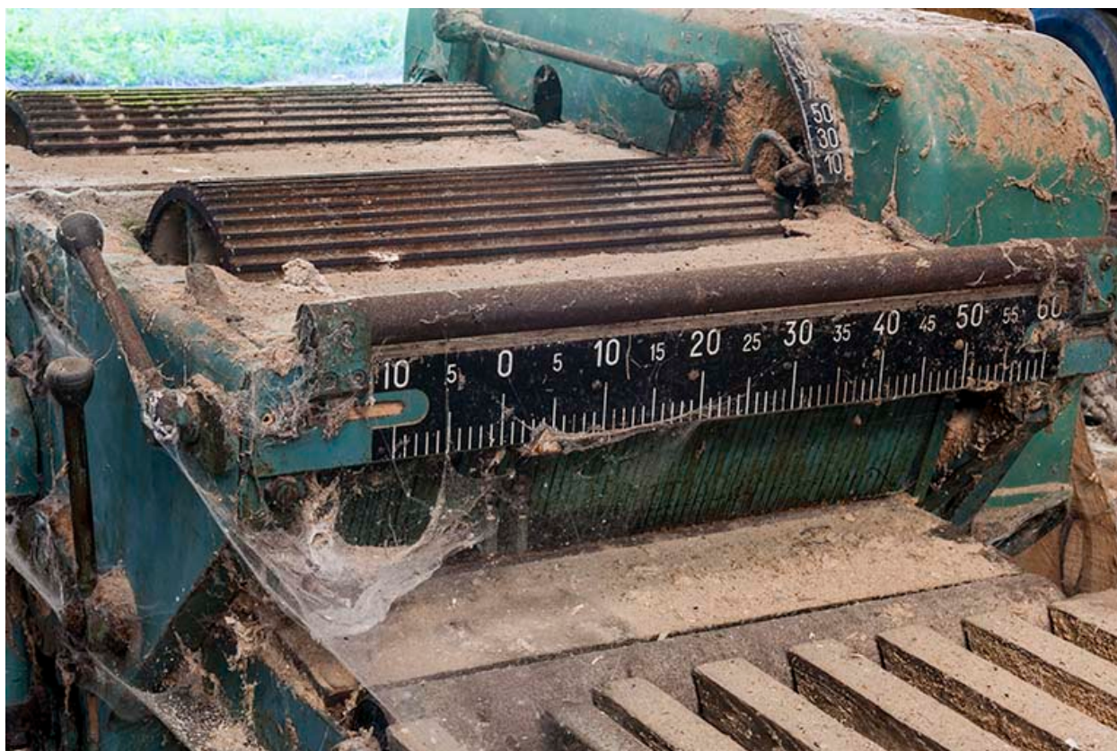
Barre de réglage de la déligneuse.
