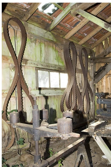
Intérieur de l'atelier d'affûtage. Lames de scie à ruban. Phot. Jérôme Mongreville IVR43_20077000619NUCA
