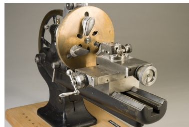
Perche, chariot porte-outil et porte-pièce, vu de trois quarts. Phot. Marc Loukachine IVR43_20122500077NUC4A
