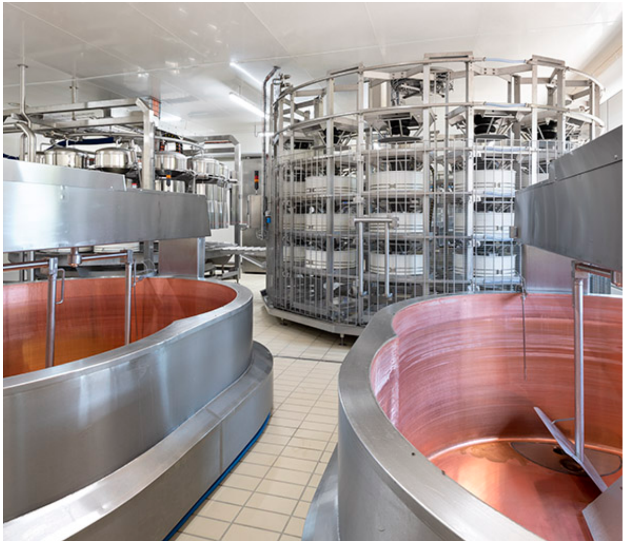
Installation de pressage, vue depuis les cuves.
