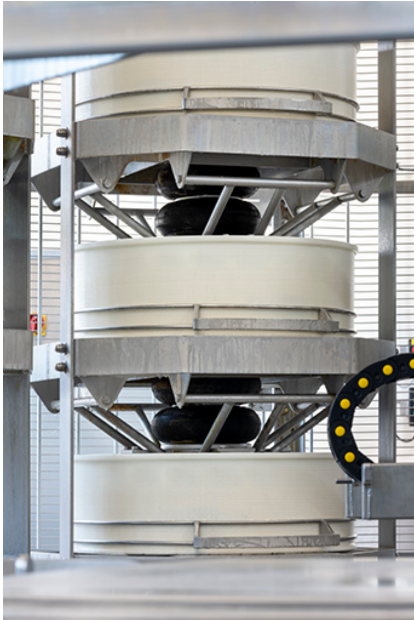
Installation de pressage : places avec moules.
