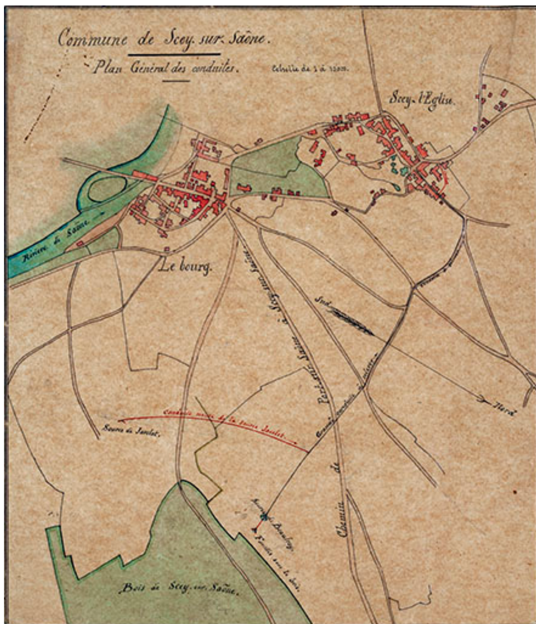
Dodelier. Plan démontrant le tracé de la conduite à établir pour amener les eaux de la source Javelot dans le troisième regard de la grande conduite à relever. 1862. Détail.
