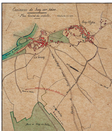
Dodelier. Plan démontrant le tracé de la conduite à établir pour amener les eaux de la source Javelot dans le troisième regard de la grande conduite à relever. 1862. Détail. Autr. Claude François Charles Dodelier, Repro. Jérôme Mongreville IVR43_20197000021NUC4A
