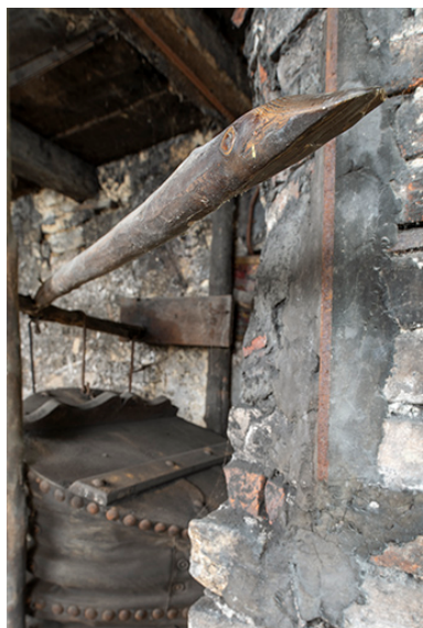
Forge : le soufflet (avec la perche servant à l'actionner). Phot. Sonia Dourlot IVR43_20192501228NUC4A
