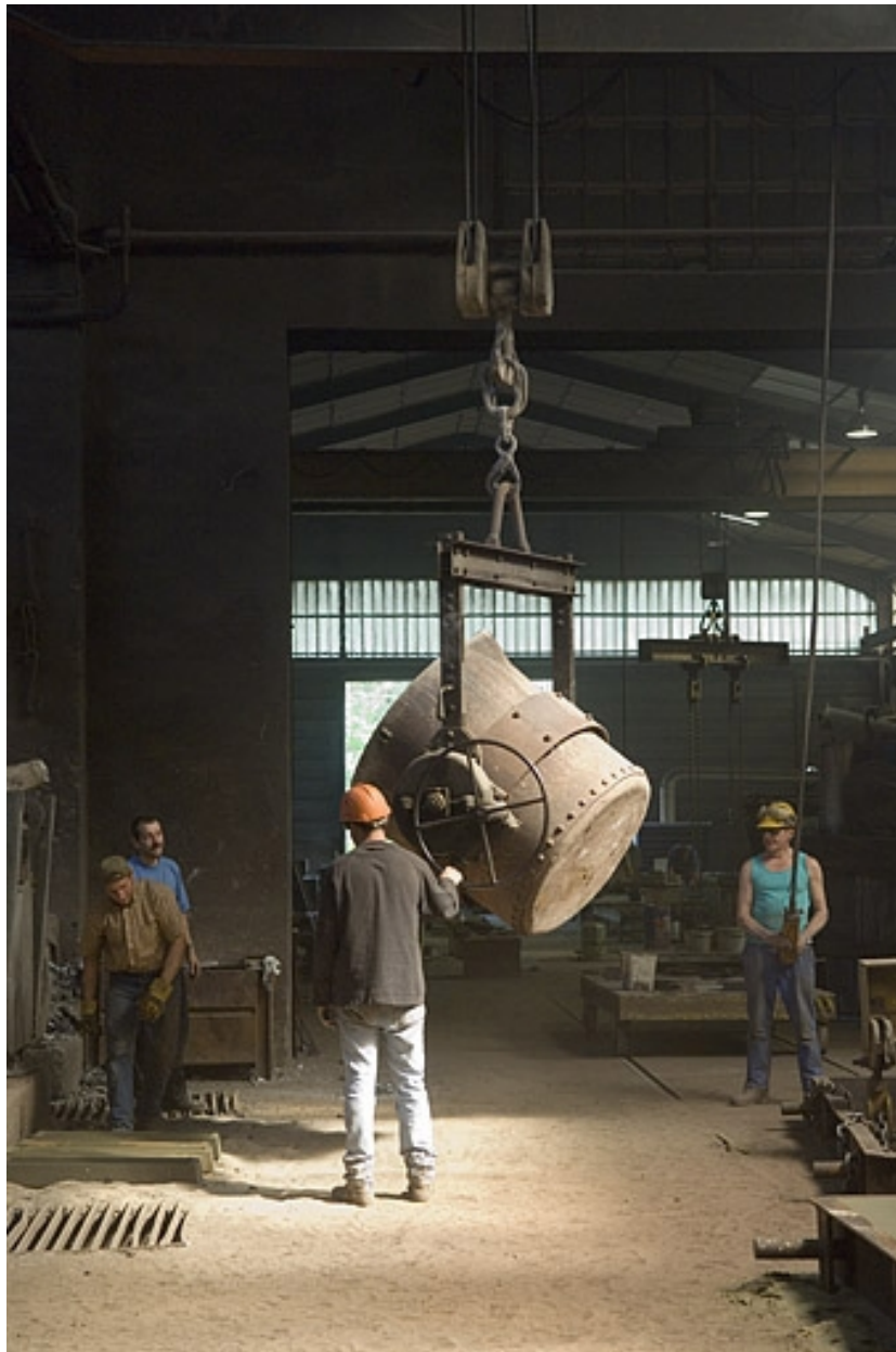
Préparation de la poche avant la coulée.
