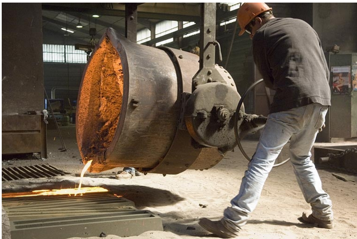
Fin de la coulée. Détail.
