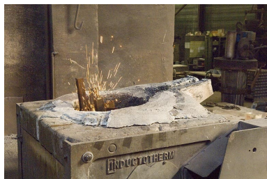
Fusion de pièces métalliques diverses dans un four.
