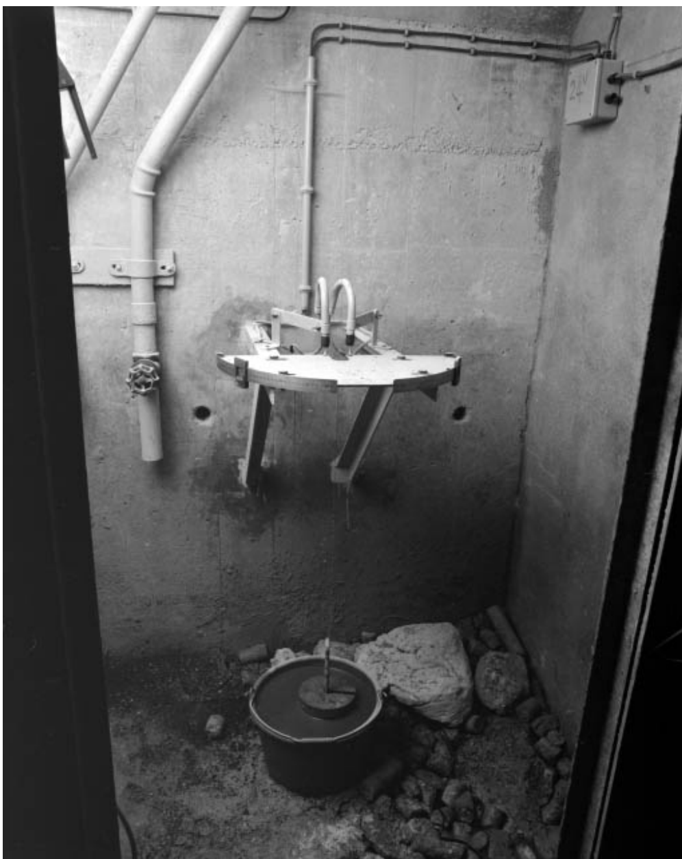
Système d'auscultation du barrage : pendule.
