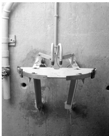
Système d'auscultation du barrage : table de lecture du pendule. Phot. Jérôme Mongreville IVR43_19913900682X
