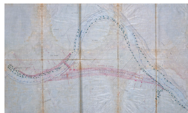
Bief de Chantes. Construction d'une dérivation éclusée, d'un barrage mobile et d'un chemin de halage - Plan général de la dérivation (1878). Phot. Jérôme Mongreville, Autr. Gustave Bouvaist IVR43_20207000082NUC4A
