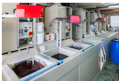
Usine : atelier de galvanoplastie (installations de l'îlot central depuis l'angle est). Phot. Jérôme Mongreville IVR43_20142500300NUC4A
