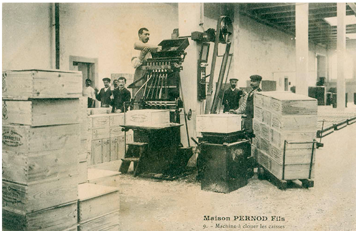
Maison Pernod Fils. Machine à clouer les caisses, carte postale, s.d. [fin 19e ou début 20e siècle].
