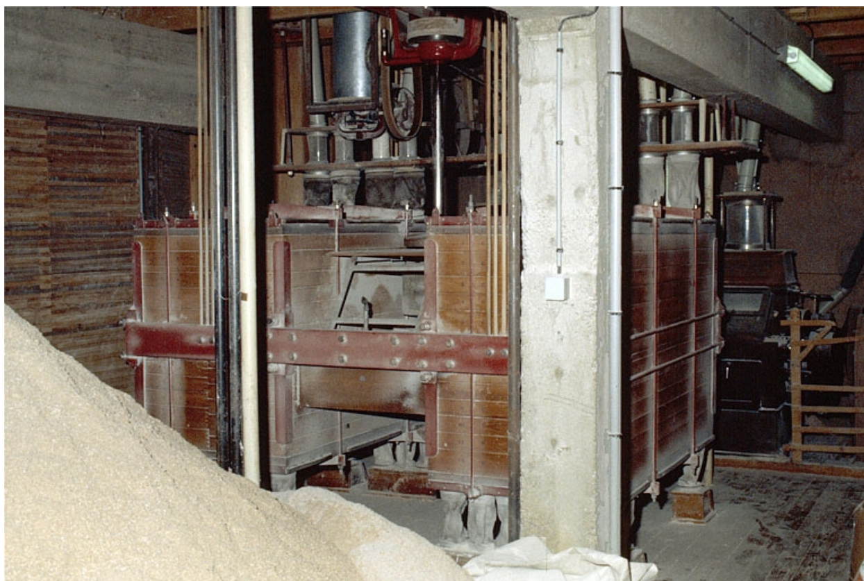
Minoterie (H), rez-de-chaussée : plansichter.
