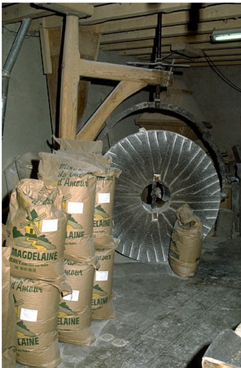
Minoterie (G), rez-de-chaussée : potence et meule.
