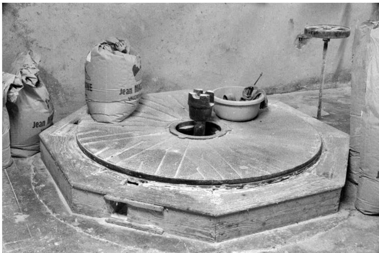
Minoterie (G), rez-de-chaussée : meule inférieure en cours de rhabillage.
